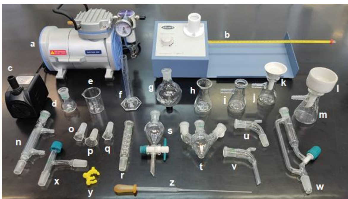
Figura 1. Equipo y material que se usa en las prácticas de Química Orgánica.
